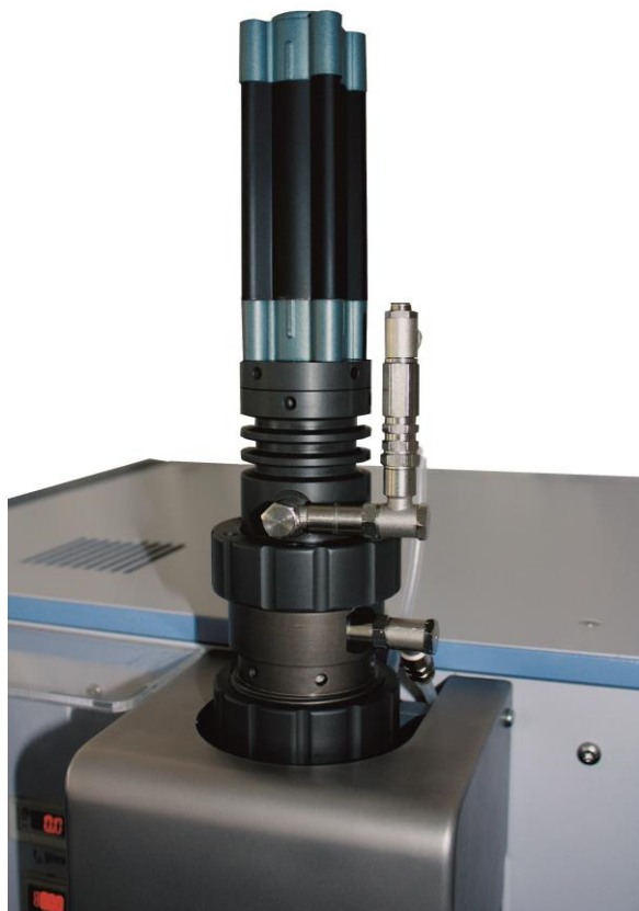
Obr 6. Nový modul automatického čištění analyzátoru G4 ICARUS.
